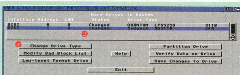
2 HDToolBox zeigt die SyQuest zwar an, hat aber noch keine Definition für das Laufwerk. Mit »Change Drive Type« ❶ erreicht man Bild 3.
